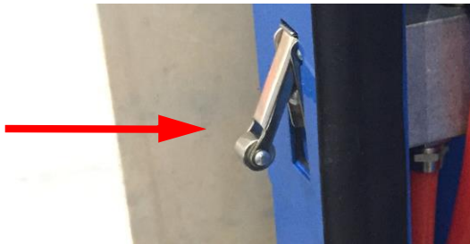
Rys. 5: Mechaniczny mechanizm zamykający drzwi
