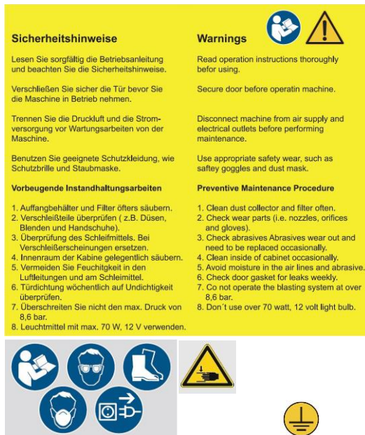
Rys. 1: Ostrzegawcze znaki bezpieczeństwa na piaskarce kabinowej SSK 4
